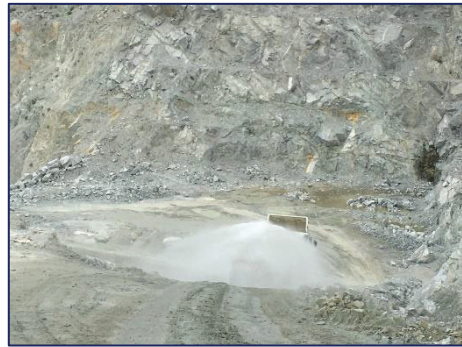
รูปที่ 2-22: การฉีดพรมน้ำบริเวณหน้าเหมือง
